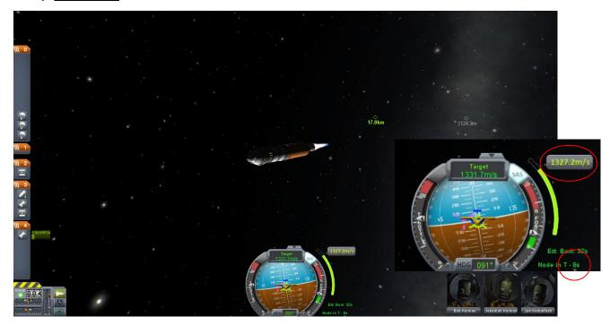
Bei T – 0s (siehe roter Kreis) wird das Triebwerk gezündet um einen Orbit zu bekommen. Die Geschwindigkeit rechts neben dem Navigationsball sinkt und sollte auf nahezu 0 m/s (rote Ellipse) gebracht werden. Dies kann jedoch mit einem großen Triebwerk kaum erreicht werden. Wenn das Ziel vorbeizieht, keine Angst, wir holen es später wieder ein.
